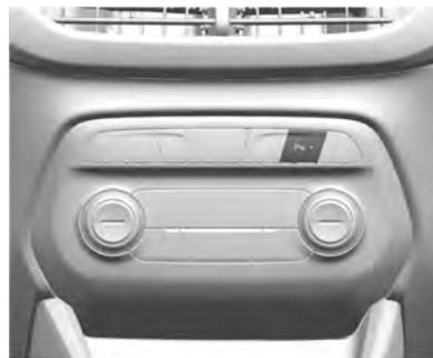
Se equipado, o botão P<sup>PA</sup> é usado para ligar ou desligar o auxiliar de estacionamento dianteiro e traseiro ao mesmo tempo. A luz indicadora próxima ao botão acende quando as funções estão ligadas e apaga quando as funções estão desligadas.
