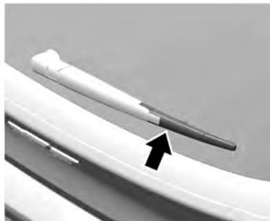
Para veículos hatchback, levante o braço do limpador. Pressione a palheta do limpador, ligeiramente inclinada para o braço do limpador, para baixo até que ela desencaixe.
