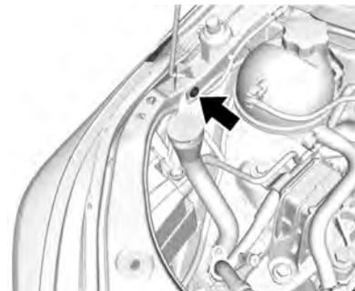
Para fazer a substituição das lâmpadas do lado do motorista, é preciso remover primeiro o bocal de enchimento do frasco do lavador do para-brisa.
