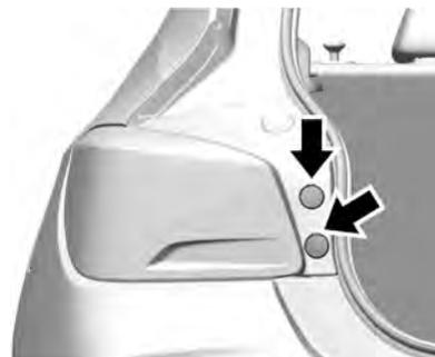
1. Remova e retenha os parafusos acoplando a montagem da lanterna na carroceria do veículo.
