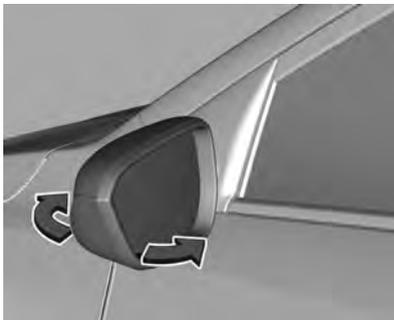
Para segurança do pedestre, os espelhos externos sairão da posição de montagem normal caso alguém colida com eles com força suficiente para isso. Reposicione o espelho ao aplicar uma leve pressão na caixa do espelho. Essa função é útil também para reduzir a largura total do veículo e evitar danos quando o veículo estiver estacionado. Coloque o espelho de volta na posição funcional antes de dirigir.
