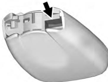
2. Separe as duas metades do transmissor usando uma ferramenta chata inserida na área próxima à fenda da chave.
