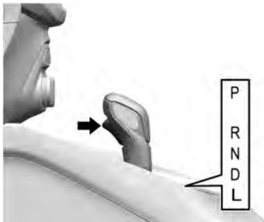
**P** : Esta posição trava as rodas motrizes. Use P (Estacionamento) ao dar partida no motor, pois o veículo não pode se mover facilmente.
