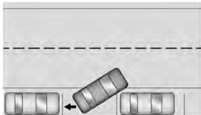
O APA instruirá o veículo a parar quando uma vaga no tamanho adequado for encontrada. Siga as instruções exibidas. Quando instruído, mude para R (Ré) para engatar a direção automática. O volante vibrará brevemente como um lembrete para que o motorista retire as mãos de cima dele. Verifique o entorno e continue freando ou acelerando como necessário, e se prepare para parar a fim de evitar veículos, pedestres e objetos.
