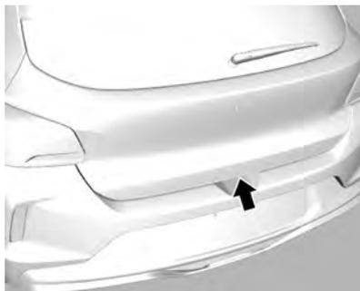
Para destravar e abrir a tampa do porta-malas por fora, pressione a superfície tátil acima da placa após destravar todas as portas.
