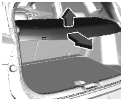
Para remover a cobertura do veículo, solte o cordão e remova a cobertura do encaixe. Para reinstalar, coloque cada extremidade da cobertura nos encaixes e prenda o cordão na tampa do porta-malas.
