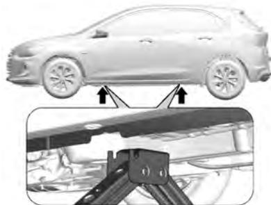
3. Ajuste o macaco até a altura necessária. Posicione-o diretamente sob o ponto de levantamento para evitar que escorregue.
