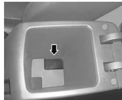
1. Coloque a chave reserva ou o transmissor dentro do apoio de braço como mostra a figura.
